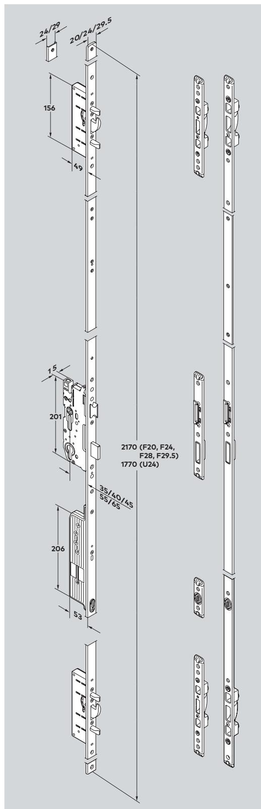
Отпирание от мотора (кратковременная и постоянная разблокировка, а также дополнительная функция собачки для запираения днем) посредством системы контроля доступа, функция передачи для разблокировки снаружи с помощью ключа. Встроенная функция аварийной эвакуации позволяет в любое время открыть дверь в направлении эвакуации простым нажатием на ручку.
