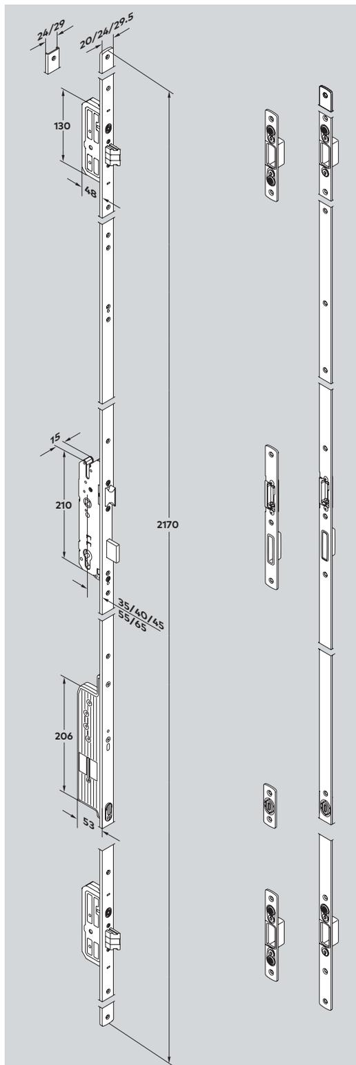
Встроенная Функция аварийной эвакуации позволяет в любое время открыть дверь в направлении эвакуации простым нажатием на ручку. Автоматический механизм запираения активирует магниты при закрытии двери.
