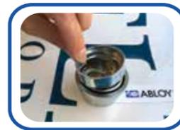
РАЗМЕЩАЕМ ЗАЩИТНЫЙ ВКЛАДЫШ И ЗАЩИТНОЕ КОЛЬЦО
